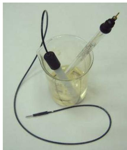
③ メータの「POWER」キーを押して電源を入れます。電極リード線のワニロクリップ側で、白金電極のプラグを挟みます。電極リード線のジャック側に比較電極端子を差し込みます。
