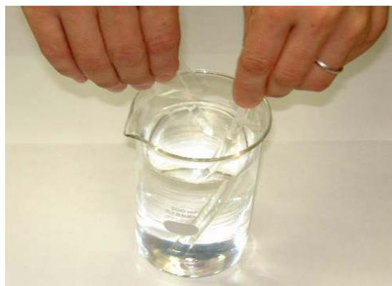
③ A剤の溶けた容器に更にORP粉末試薬のB剤を1袋全量(0.3g)入れて、攪拌棒でよく攪拌します。B剤が一部溶けずに残る事もありますが、そのまま使用します。
