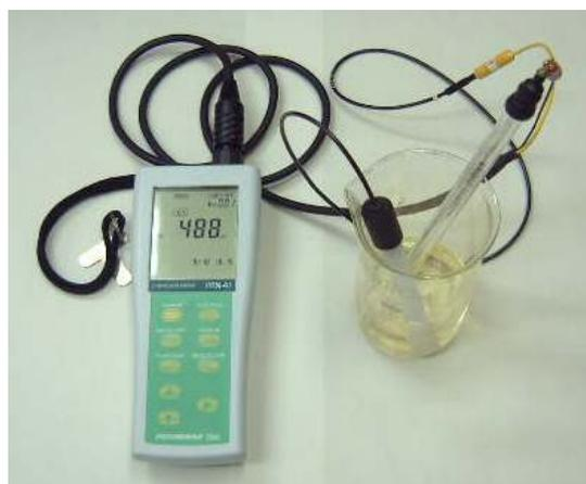
④ リアルタイム測定状態で、測定値が450～500mVで安定している事を確認して下さい。
