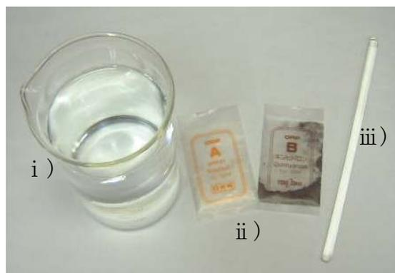
② 純水500mLの入った容器にORP粉末試薬のA剤を1袋全量入れて攪拌棒でよく攪拌し、試薬を溶かします。
