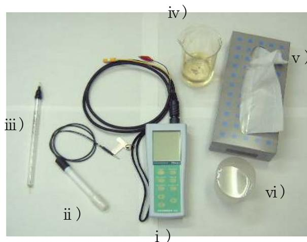
② ORP標準液に白金電極と比較電極を浸します。白金電極は銀色の細い方の側を標準液に入れます。金色の太い方(プラグ側)を標準液に入れないで下さい。比較電極は乾燥防止キャップを外し、濡れている部分をティッシュペーパーで拭いてから、標準液に入れて下さい。
