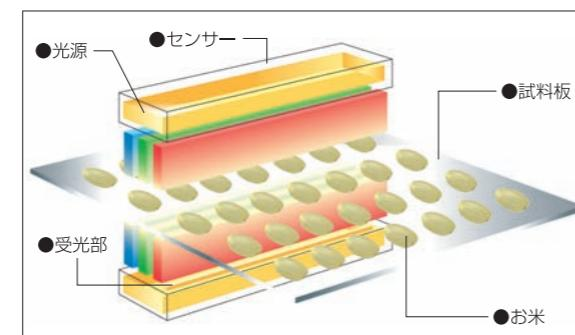
高性能センサーでお米の両面を測定するので斑点粒などを見逃さず撮像できます。
