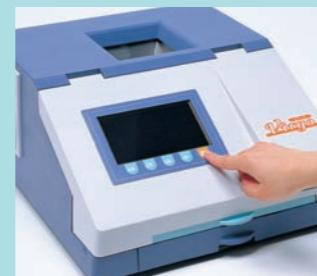
測定ボタンを押します。自動整列で自動測定します。
