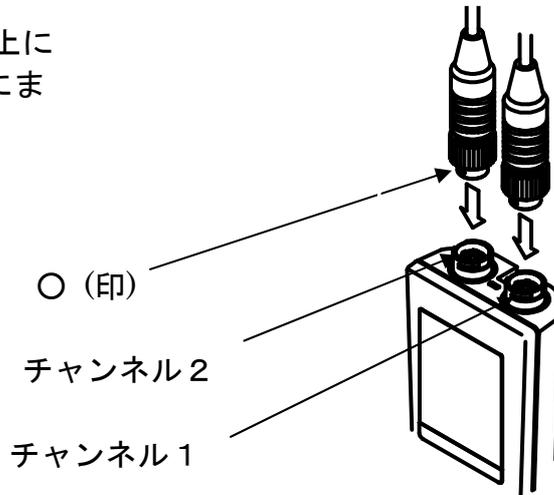
③ 固定リングのみを回し、電極プラグを固定します。このとき、プラグ本体は回さないで下さい。
