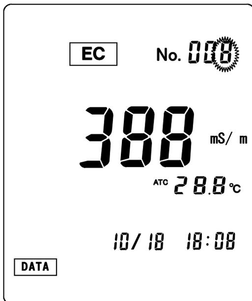
最後にデータメモリした際の、ナンバ、測定値、温度、時刻が表示されます。
