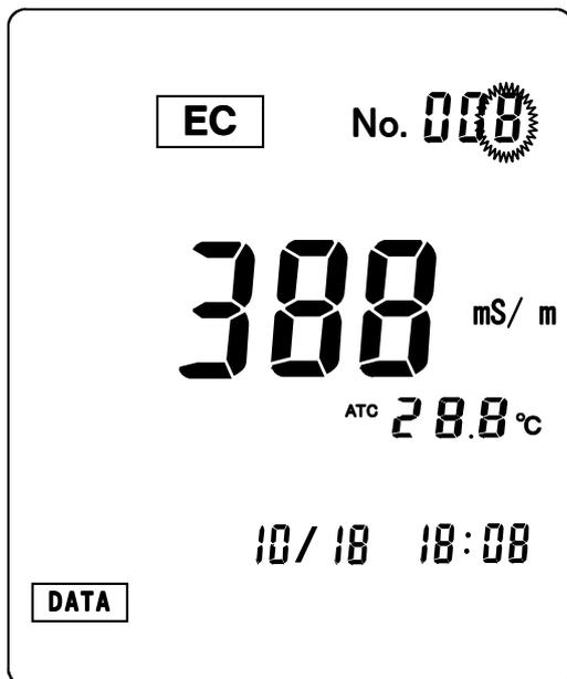
最後にデータメモリした際の、ナンバ、測定値、温度、時刻が表示されます。印字したいデータを表示させる場合、▶キーを押す毎に、点滅箇所が 百位→十位→一位と移動していきます。点滅箇所にて▲▼キーにより数値設定を行います。(メモリデータナンバを設定します。)
