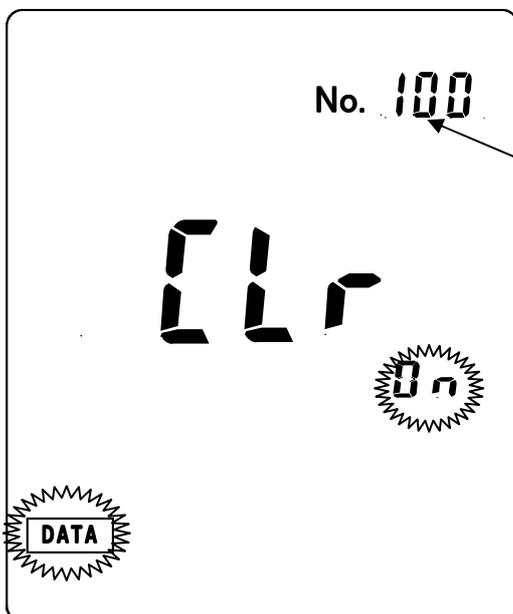
現在メモリされているデータナンバの最大が表示され、データが一つずつ削除されていくと同時にデータナンバが減っていき全削除が完了すると測定画面に戻ります。
